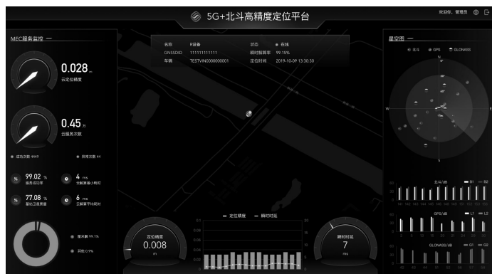
图 6 基于 GNSS 信号定位 MEC 定位解算典型测试结果
